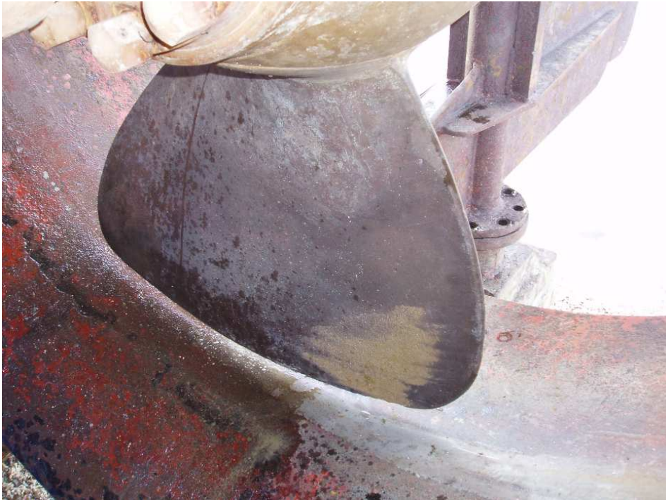
Pale d'hélice corrodée par cavitation
